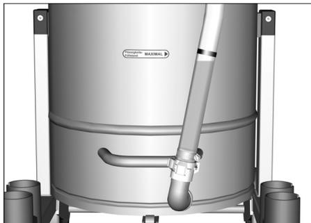
**Indicație:** Marcajul roșu de la furtunul de aspirație indică nivelul de umplere maxim.
