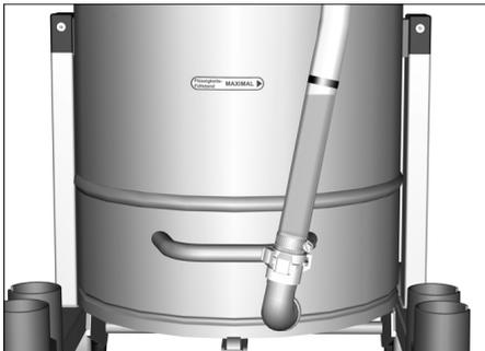
**Hinweis:** Die rote Markierung am Ablassschlauch zeigt den maximal zulässigen Füllstand an.
