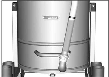
**Anmärkning:** Den röda markeringen på avtappningsslangen visar den maximalt tillåtna nivån.
